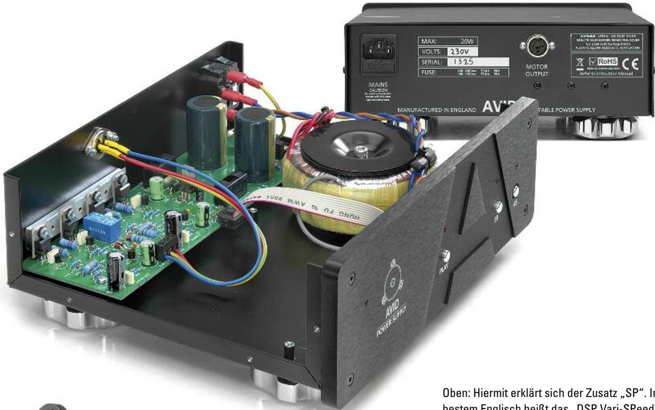
Oben: Hiermit erklärt sich der Zusatz „SP“. In bestem Englisch heißt das „DSP Vari-Speed control unit“. Das digital gesteuerte Netzteil für die stufenlos regelbare Geschwindigkeitskontrolle ist wie alles bei Avid aus dem Vollen geschmitten. Sprich, mit dieser Elektronik und dem Netztrafo bauen andere Firmen Verstärker. Der Klang gibt Conrad Mas recht
