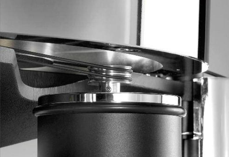
Diese Aufnahme verdeutlicht sehr schön, wie die Riemen um das Motorpulley in Richtung Innenteller gespannt sind. Fürs Foto sind sie nicht horizontal justiert: So würden sie beim Anschalten abrutschen
