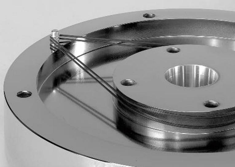
Links im Teller ist der Nupsi zu erkennen, mit dessen Hilfe man die beiden Riemen vorspannt und um den Innenteller fixiert. So wird der Teller umgedreht, die Riemen um den Pulley gelegt, manuell gedreht und dann darf der Nupsi gehen
